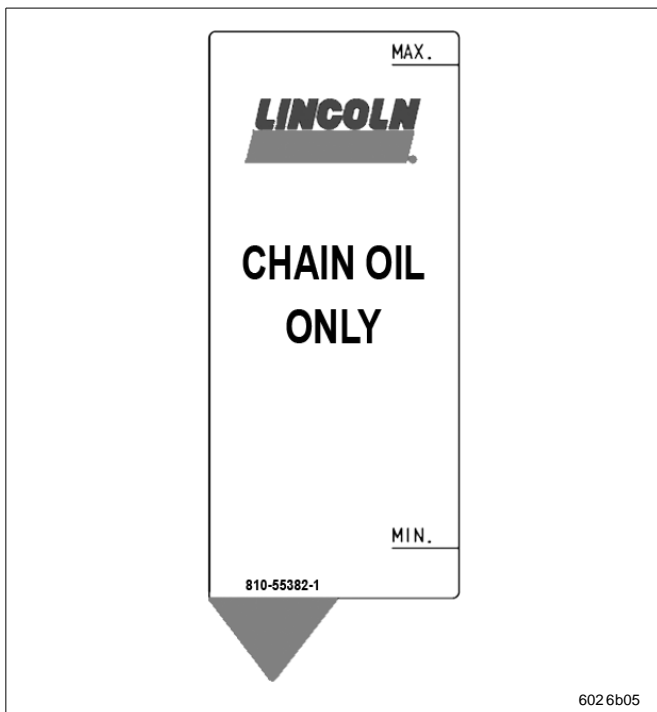
Abb. 5-1 Füllstandsanzeige der MOP101
