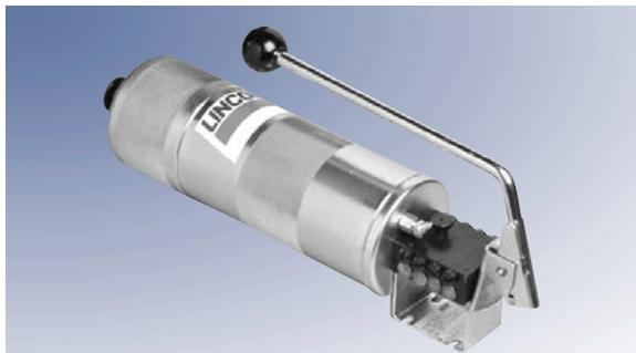
Diese preiswerten handbetätigten Einhubpumpen fördern eine genau bemessene Schmierstoffmenge, Fett oder Öl, je nach Modell. Die Fettschmierpumpen HP und HPG sind mit einer federbelasteten Folgeplatte und einem Kontrollstab zur Schmierstoffkontrolle ausgestattet. Die Ölschmierpumpe besitzt einen transparenten Kunststoffbehälter zur optischen Niveauüberwachung. In Verbindung mit SSV-Verteilerblöcken können diese Einhubpumpen 1 bis 64 Schmierstellen mit Schmierstoff versorgen.
