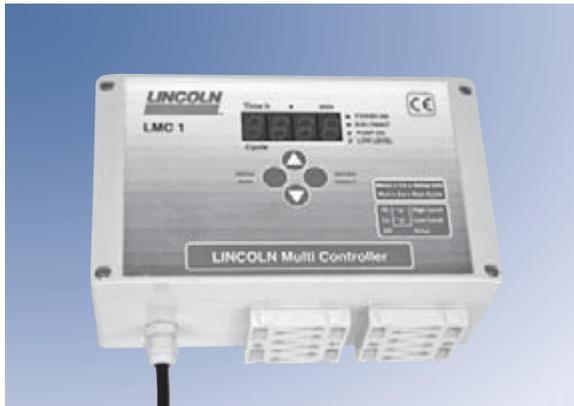
Flexibel einsetzbares Steuergerät für kleine bis mittelgroße Systeme. Die hier aufgeführten LMC1 Steuergeräte sind bereits für Einleitungssysteme voreingestellt. Das Konfigurationsmenü erlaubt die Einstellung der Arbeitsparameter.
