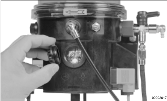
Abb. 7: - Verschlußdeckel zur Steuerplatine entfernt
