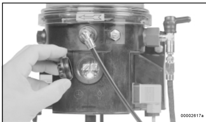
Abb. 13 - Verschlußdeckel zur Steuerplatine entfernt
