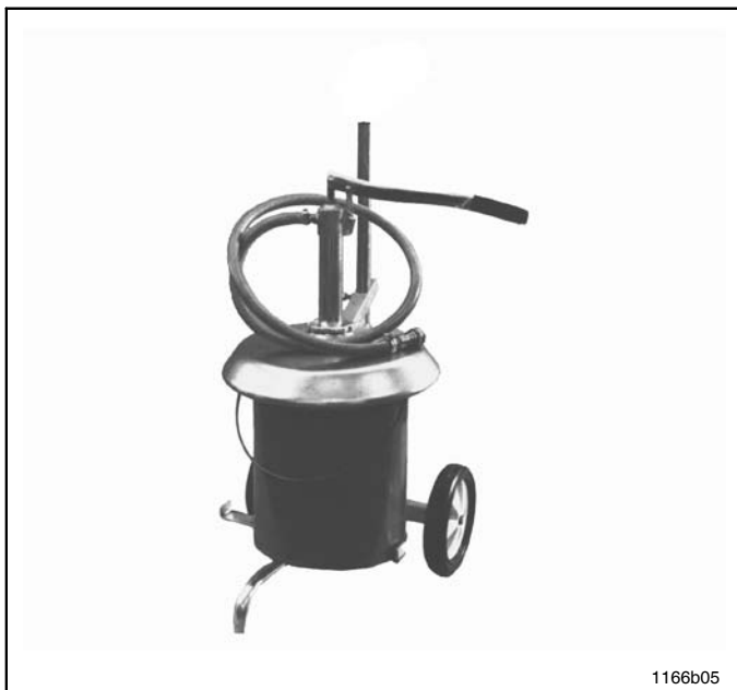
Abb. 26-1 Pumpe, handbetätigt, für Fette bis NLGI Klasse 2 (50 kg)
