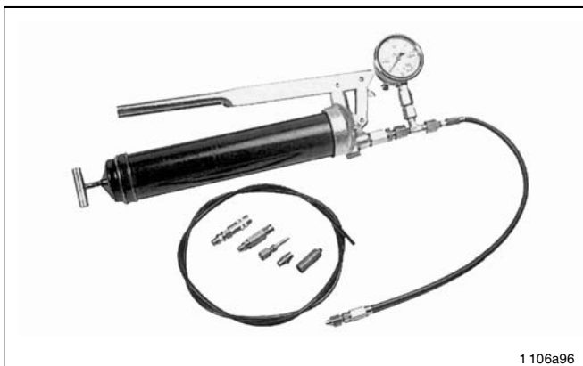
Abb. 24-5 Druck- und Funktionsprüfsatz: u. a. Handhebelpresse 1142, Manometer D63 0-600 bar und Versraubungen Sach-Nr.: 604-36879-1
