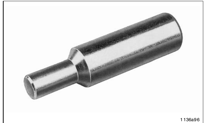
Abb. 24-2 Montagesutzen für Schlaucheinbindung Sach-Nr.: 432-23077-1
