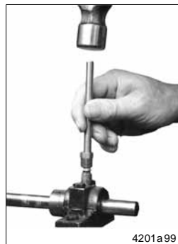
Abb. 2-2 Montage des Zerk-Lock-Körpers mittels Treibwerkzeug
