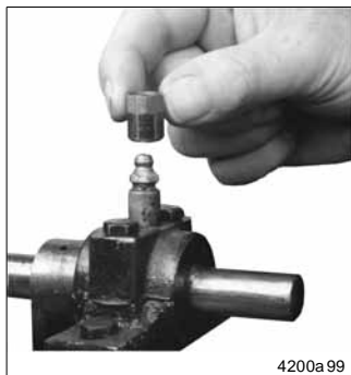
Abb. 2-1 Zerk-Lock-Körper auf den Schmiernippel setzen
