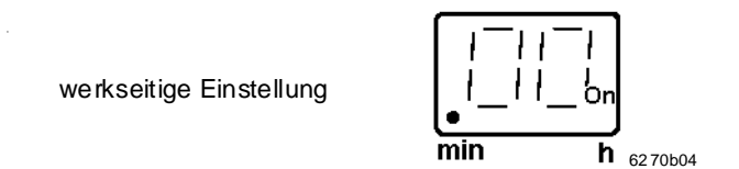
Abb. 12-5 Werkseitige Einstellung der Pausenzeit "P2" (Minuten)
